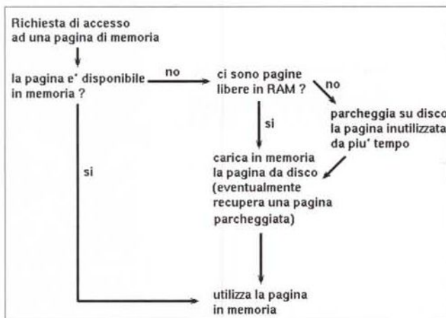
Principio di funzionamento dei meccanismi di gestione ed ottimizzazione della memoria descritti.
